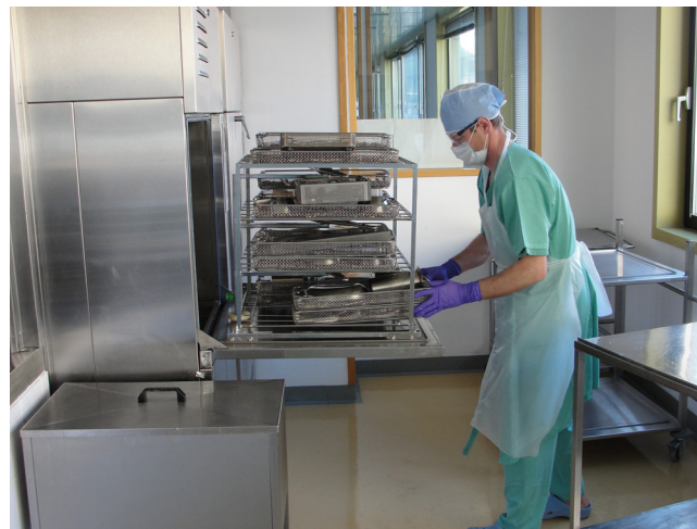
Nečista cona CS – nalaganje mrež z instrumenti v termodezinfektor (Vir: arhiv Oddelka CS)
