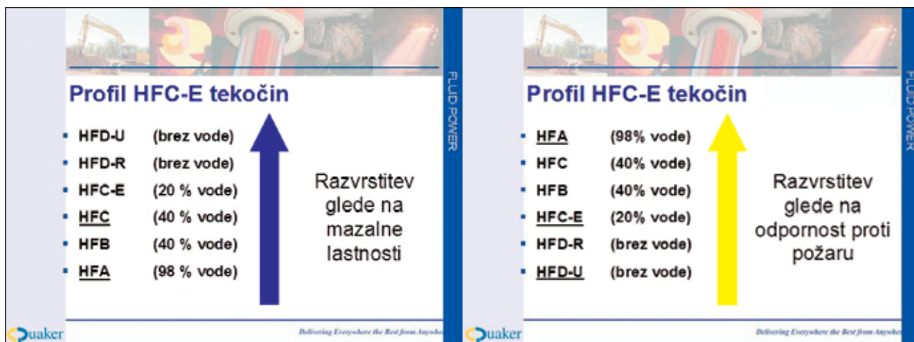
Slika 3. Primerjava mazalnih lastnosti in odpornosti proti požaru
