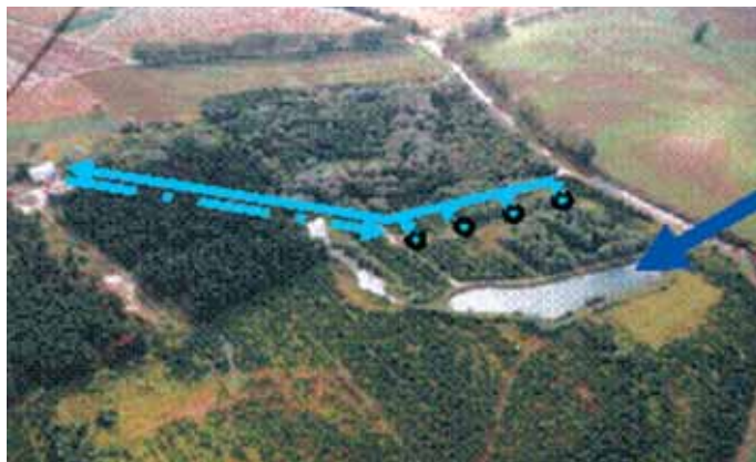
Slika 4 • Leta 1998 zgrajeni bazen z dovodom vode iz Drave, vodnjaki in cevovoda za črpanje in vračanje s kisikom zasičene vode
