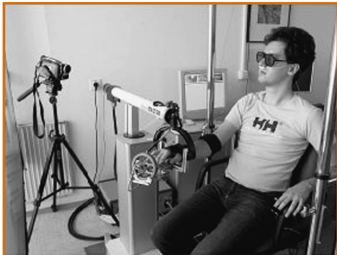
Slika 4: Oseba med vadbo s HENRiE sistemom: mehanizem za prijemanje je nameščen na vrh HapticMaster haptičnega vmesnika, 3D projekcijski sistem je nameščen pred osebo, dve manšeti za roko povezujeta z dvema motorjema kompenzatorjev gravitacije, nameščenima na stropu nad osebo.
