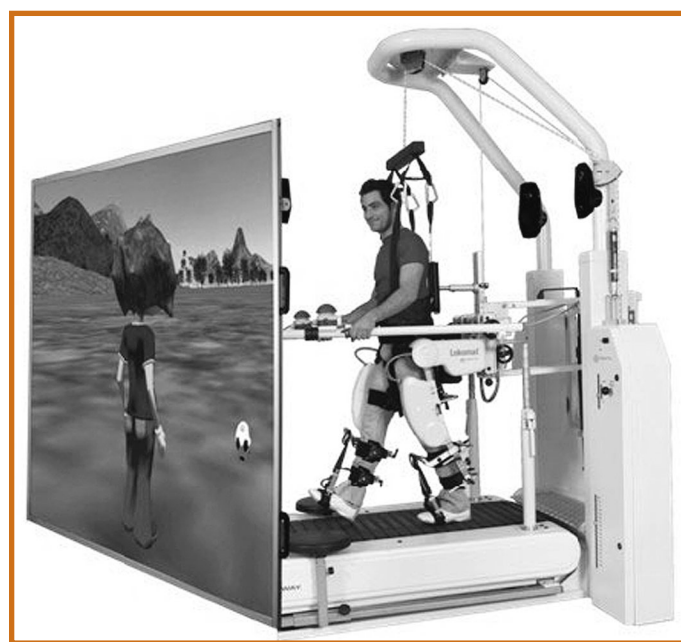
Slika 3: Robotska naprava Lokomat za vadbo hoje skupaj z vidnim zaslonom in zvočnim sistemom
