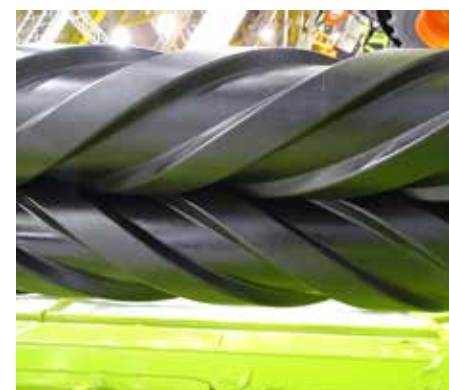
Segment valjčnega gnetilnika na Claasovi kosilnici DISCO. Ti gnetilniki so primernejši za metuljnice.
