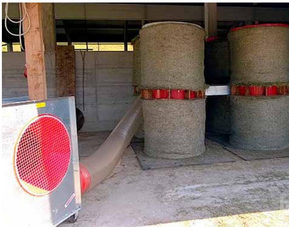
Na vrh postavimo še štiri bale, sušilnik s fleksibilno cevjo povežemo z ventilatorjem in sušenje se lahko prične. Vidni so pokrovi na gornjem sloju bal, s katerimi preprečimo uhajanje zraka skozi sredico (Foto: Rotometal).
