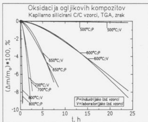
Slika 3: Oksidacija laboratorijsko in industrijsko izdelanih C/C vzorcev. Naključna odstopanja se povečujejo s časom oksidacije oziroma z neenakim povečevanjem reakcijske površine
