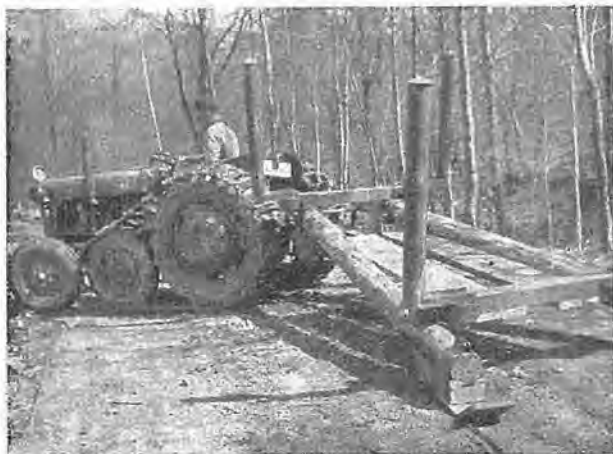
Slika 5. Največji mogoči horizontalni kot, ki ga zmore traktor s sanmi, je ok. 40^{\circ} (orig.)
