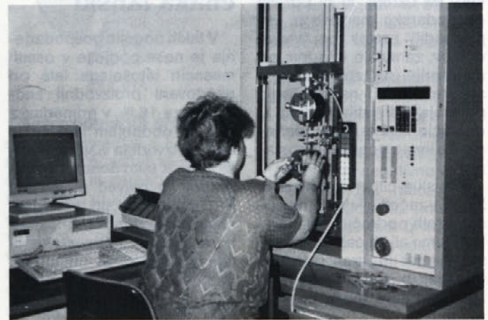
Sredi julija so v obratu Nove valjarne dobili testirni stroj za merjenje mehanskih lastnosti titancinkove pločevine. Enakega imajo tudi v PE Veflon za testiranje PTFE in gume.
