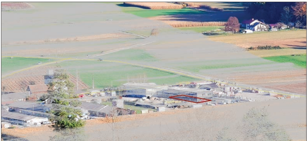
Slika 4: Zajem novega objekta z interaktivno orientacijo: sive točke predstavljajo projicirane DMR, rumene črte so vektorji cest, rdeča črta je obod nove stavbe (podložena fotografija: Natalija Novak).
