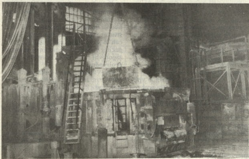
Saržiranje EP v jeklarni (foto Arzenšek)
