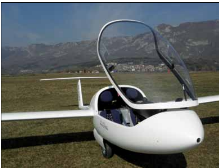
Izdelek, ki je trenutno paradni konj podjetja Pipistrel tako v energetskem kot v tehničnem smislu: električno letalo Electro Taurus
