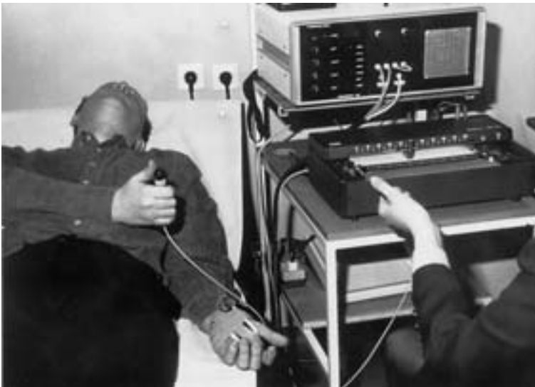
Slika 1. A – termotester s termodo, ki jo na del, ki ga pregledujemo, pritrdimo z elastičnim trakom. B – preiskovanec s pritiskom na stikalo spremeni smer toka in s tem temperaturo. Stikalo pritisne takoj, ko začuti, da je postal stimulator toplejši ali hladnejši (dražiti začnemo vedno s temperaturo 30 °C, ki je v nevtralnem območju). Spreminjanje temperature zapisujemo s peresnim pisalnikom.
