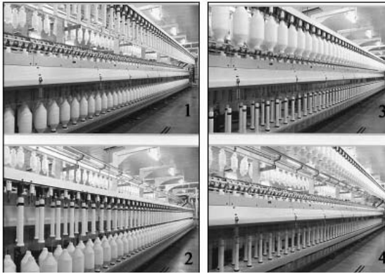
Slika 30: Potek avtomatiziranega snemanja bikoničnih navitkov in natika praznih cevkv na krilniku družbe Marzoli [6]
