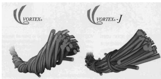
Slika 45: Model zgradbe predivne preje VORTEX in VORTEX-J [6]
