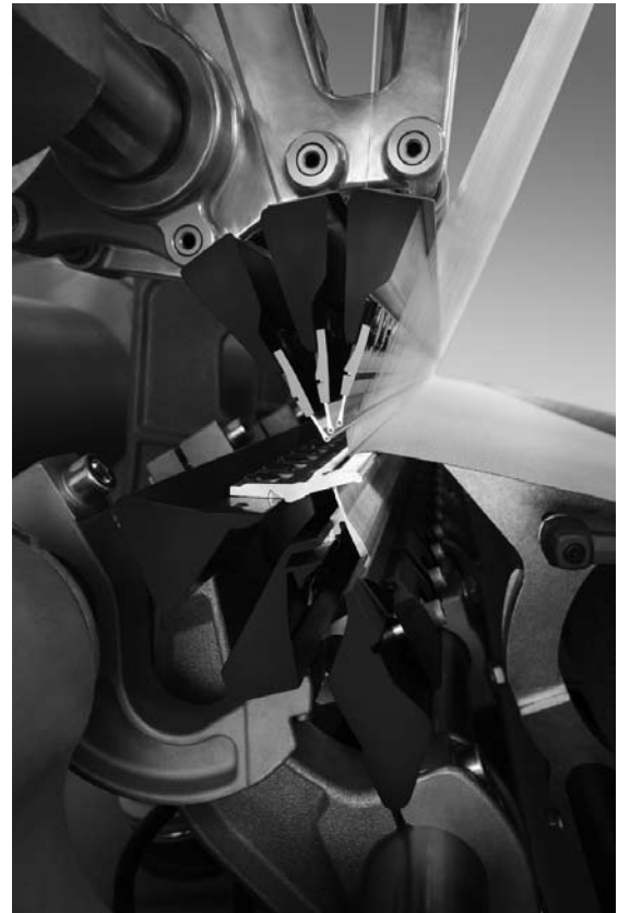
Slika 9: Igelnice in polagalniki Karl Mayerjevih snutkovnih pletilnikov so lažje konstrukcije.
