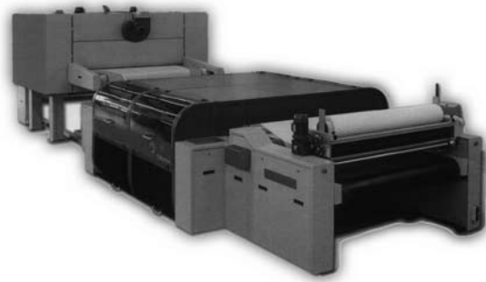
Slika 5: Industrijski tiskalnik za tiskanje tkanin, pletenin ali netkanih tekstilij DReAM Reggiani [6]
