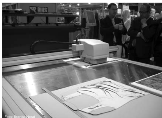
Slika 9: Tiskanje krojnih delov oblačila s ploskovnim tiskalnikom SIP-160F Shima Seiki (J) [Foto: Branko Neral]
