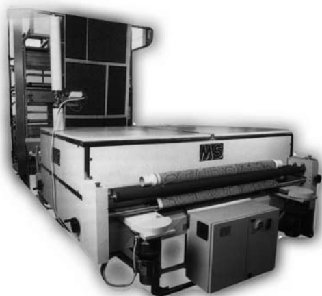
Slika 2: Sušilnik MS-Ministenter in enota za pranje digitalnih odtisov reaktivnih ali kislih barvil MS-Washer MS (I) (4 kadi, vsaka z zmogljivostjo 80 L, hitrost dovajanja 0,5–3 m/min, kadi ogrevane z oljem/paro, višina 2860 mm) [4]
