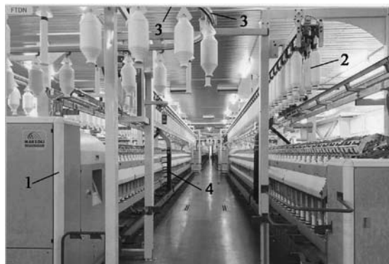
Slika 29: Avtomatizirano snemanje, čiščenje in viseči transport bikoničnih navitkov na krilniku družbe Marzoli [6]
