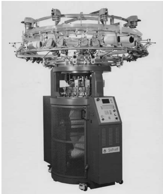
Slika 8: Santoni je pri svojem pletilniku za brezšivno pletenje SM9 preoblikoval pletilno glavo.
