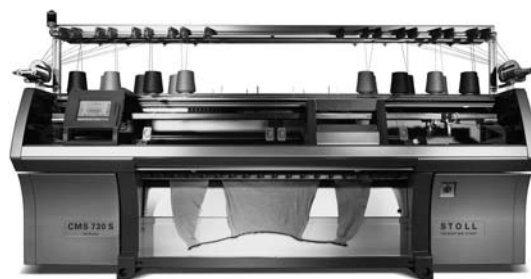
Slika 3: Stoll je na Itmi'07 prvič predstavil pletilnik CMS 730 S z delitvijo 18E in novimi vzorčnimi možnostmi.
