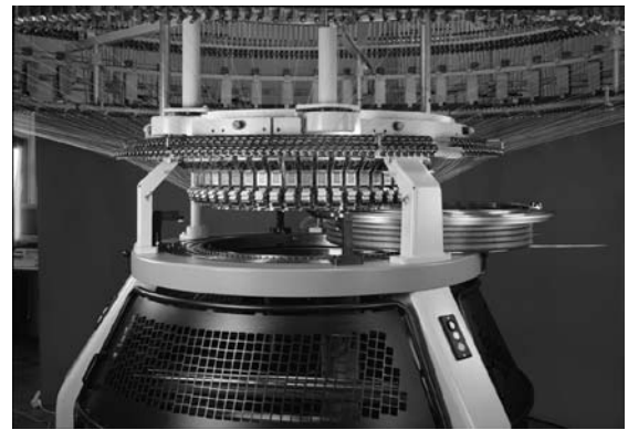
Slika 7: Igelnice pletilnikov Mayer&Cie je mogoče hitro zamenjati po sistemu Quick-Change.
