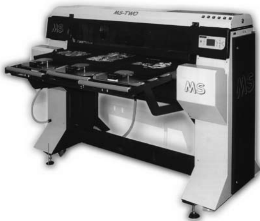
Slika 3: Tiskalnik za kosovni tisk majic ali substratov manjših dimenzij in različnih surovinskih sestav MS-Two MS (I) (največja širina tiska 1100 mm, največja debelina 100 mm, resolucija tiskanja od 360 dpi do 2880 dpi, 4 do 8 barvil ali 4 barvila in dodatna bela za tisk temnih substratov) [4]
