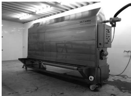
Slika 13: Parilnik Portafix Setema (NL) [12]
