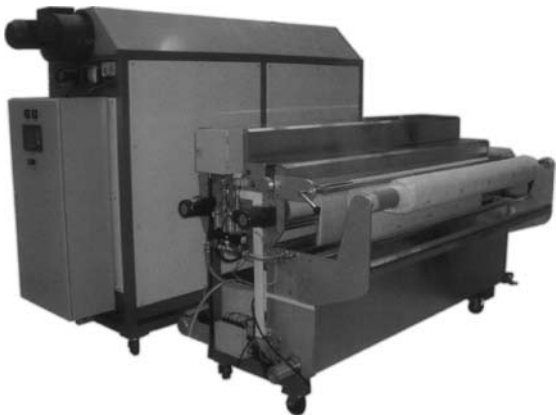
Slika 11: Impregnirno/pralna enota Wash-X-1660-2200 Rimslow (AU) [11]
