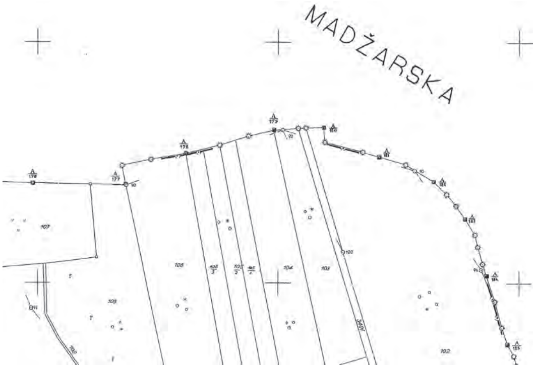
Slika 5: Primer grafičnega izseka iz zemljiškokatastrskega načrta k. o. 1 Hodoš, na katerem je vidna skladnost mej zemljiškokatastrske izmere iz leta 1959 z linijo državne meje. Vidne so oštevilčene kvadratne oznake mejnih stebrov in vmesne okrogle oznake mejnih kopic (tako imenovanih humk) na državni meji (vir: https://gis.gov.si/ezkn/ ).
