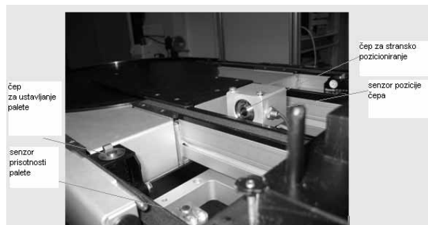
Slika 1. Krožni tekoči trak s pozicionirnim čepom, čepom za ustavljanje palet in senzorjem prisotnosti palete na odjemalnem mestu
