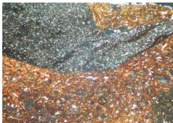
Slika 8. Fotografija zbruska vzorca MP185 z Maharskega prekopa, ki kaže osnovne značilnosti lončarskega recepta 4. Na vrhu je veliko zrno roženca. Fotografija je posneta z optičnim mikroskopom pri 40-kratni povečavi, pri izključenem analizatorju, širina posnetka je 2 mm (foto: A. Žibrat Gašparič).
