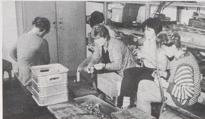
PREDILNICA: Čiščenje in mazanje obešank za obešanje predpreje.
