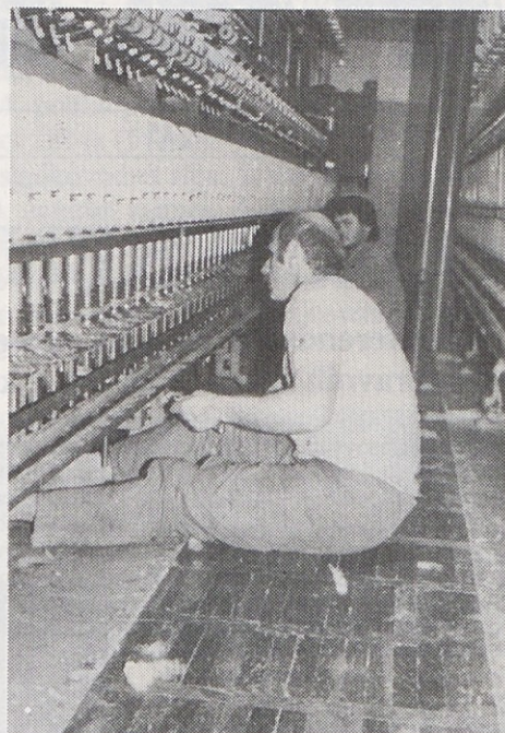
PREDILNICA: Menjava plastike na raztezalnem jermenu vretenskih trakov.
