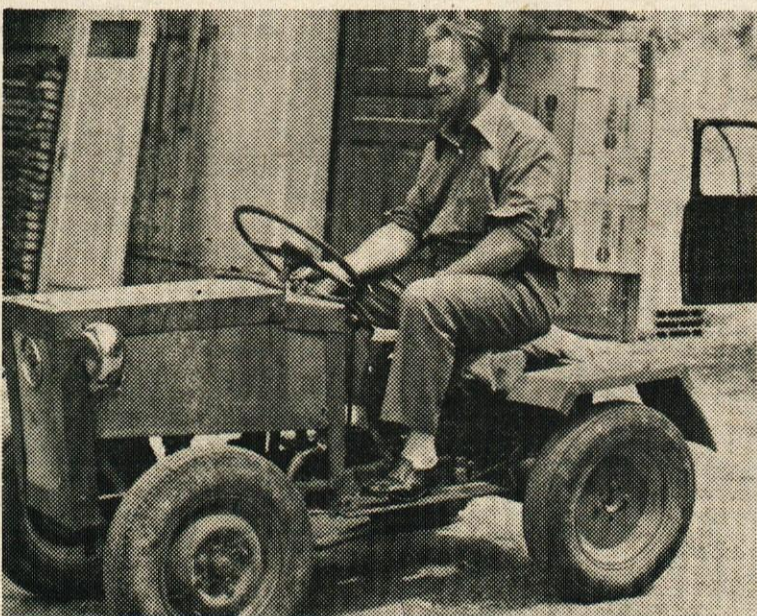
Za tale traktorček „made in doma“ je Ceglarjev ata iz Male Kostrevice porabil dele dotrajanega fička in mopeda, ter nekaj zimskih mesecev ... (Foto: Dane)
