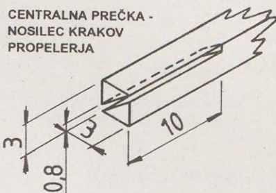
Risba 7. Določanje kota 40° na centralni prečki – nosilcu krakov propelerja
