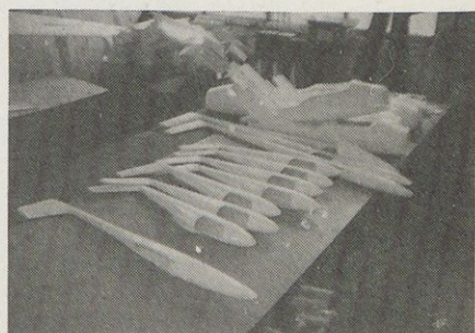
Trupi za vse tipe modelov so izdelani iz kompozitnih materialov.
