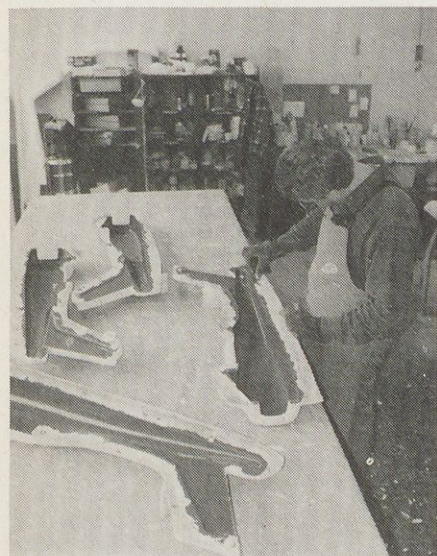
Čiščenje in priprava kalupov za ponovno uporabo
