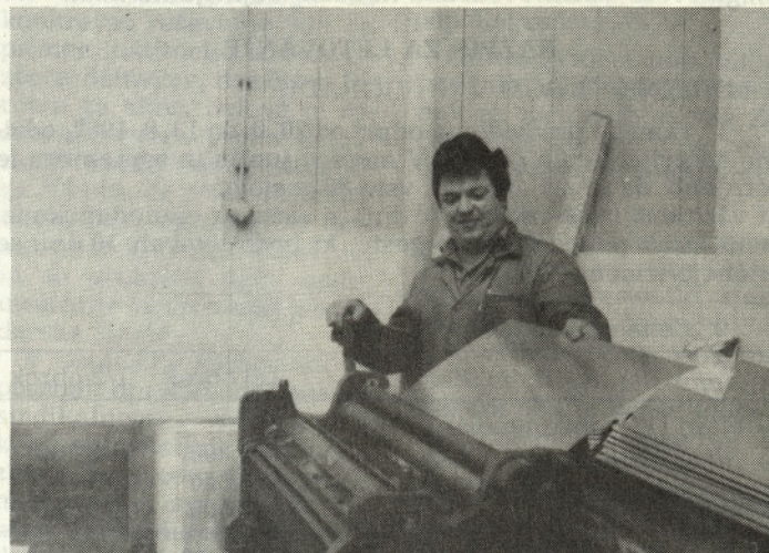
Albin s polno paro krivi in pribija obrobe, za kar bo porabil 400 tekočih metrov aluminijaste pločevine
