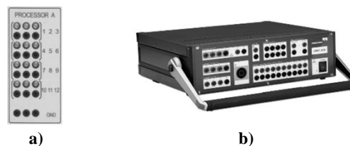
Slika 4. a) kartica GPC z vmesnikom na prednji plošči, b) ojačevalec (ojačevalnik signala)
