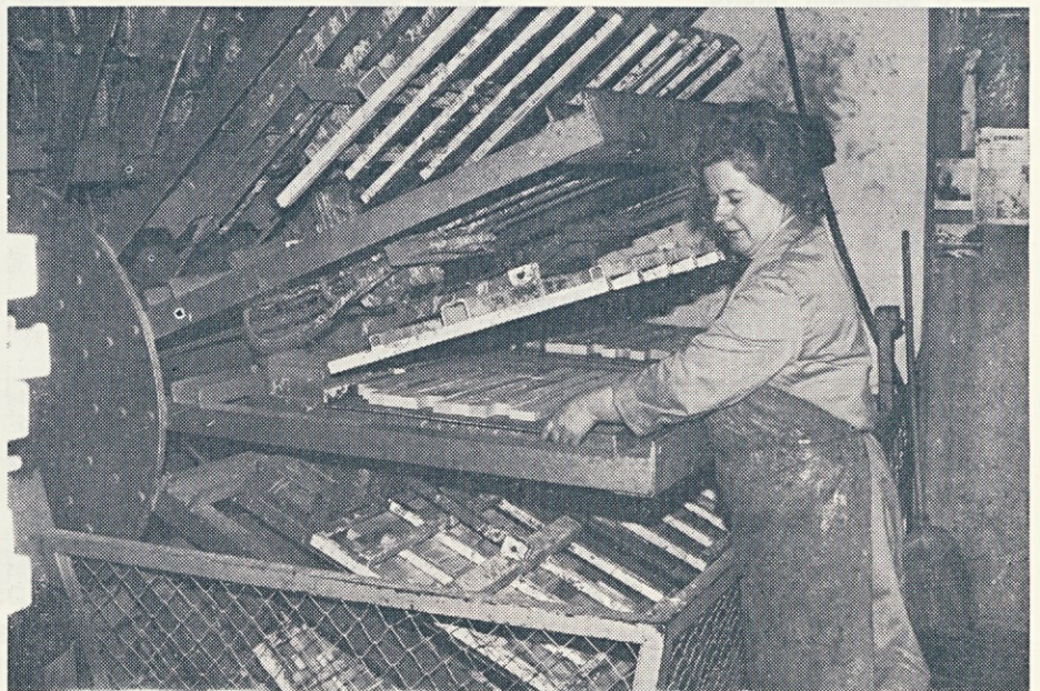
LEPLJENJE SREDIC ZA SEDEŽE ZA KMEČKE STOLE OPRAVLJA DELAVKA NA POSEBNI NAPRAVI, KI JE PODOBNA VELIKEMU, VRTEČEMU SE KOLESU. DEŠČICE STISKAJO ZRAČNI BATI. KO SE VRTEČA NAPRAVA OBRNE ZA 360°, JE LEPILO ŽE TOLIKO SUHO, DA SE ZLEPLJENE SREDICE LAHKO POLOŽI NA STOJKO.
