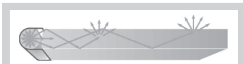
□ Slika 2. Shematski prerez ploskovnega izpusta svetlobe. Linijski izpust (svetlobni vodnik z linearno porazdelitvijo sipalnih jeder) je usmerjen v ploščo s ploskovno porazdeljenimi sipalnimi jedri. Pri ploskovnih svetilih (svetlobni panoji) nastopajo namesto linijskega izpusta linijski izvori svetlobe - fluorescentne cevi
