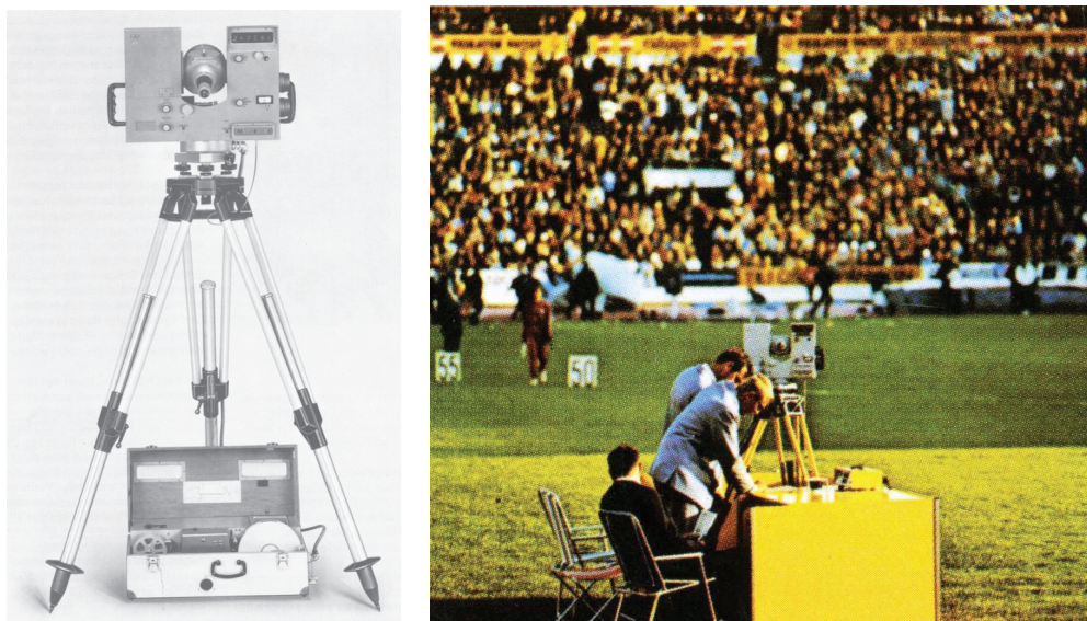
Slika 1: Tahimeter Zeiss RegElta 14 s sistemom za registracijo merjenih vrednosti in njegova uporaba na olimpijskih igrah v Münchnu leta 1972 (Opton, 1972)
