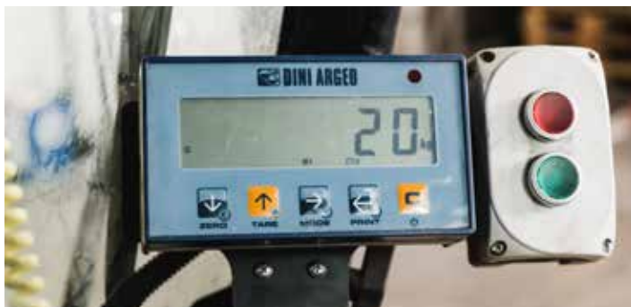
Viličar, opremljen z digitaliziranim tehtalnim sistemom
