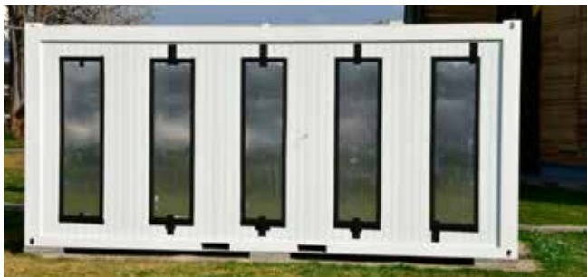
Foto 4: STAF paneli, ki smo jih namestili na testni kontejner za izvajanje meritev učinkovitosti.
