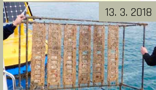
Foto 4: Vzorci nezaščiteni in zaščiteni aluminijeve zlitine Al-Si9-Cu3 po enomesečni in osemmesečni potopitvi v Jadranskem morju. Razviden je razvoj obrasti mikroorganizmov, ki je bolj izražena pri nezaščiteni zlitini. Prevleki torej upočasnjujeta razvoj obrasti.
