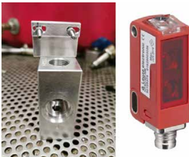
Slika 2 : Namenski aluminijasti hidravlični blok (70 mm x 50 mm x 30 mm) (levo) in optični senzor (desno) [10]
