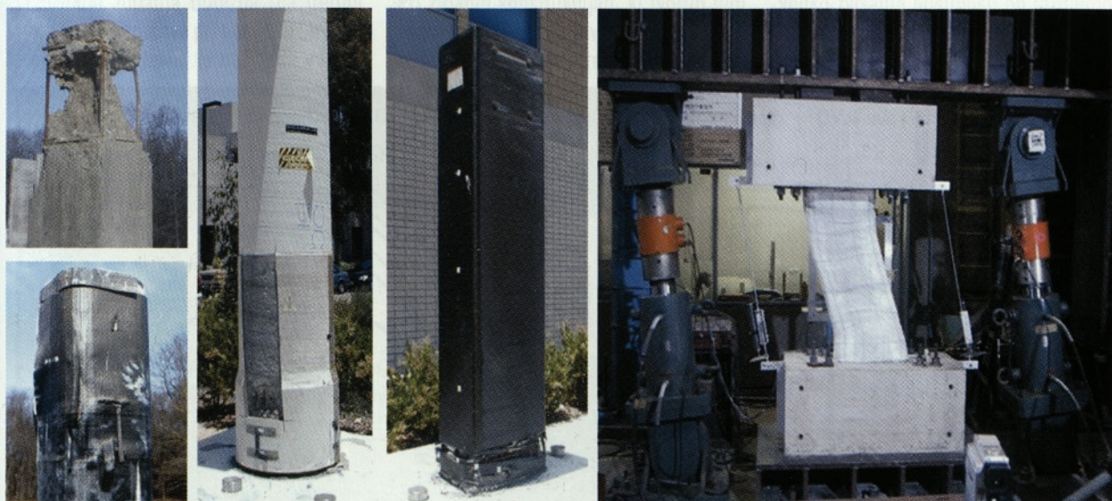
Slika 4: Primeri preiskanih stebrov v laboratoriju ELSA v Ispri (a), v laboratoriju UCSD La Jolla (b in c) ter v laboratoriju Nacionalne univerze v Yokohami na Japonskem (d).
