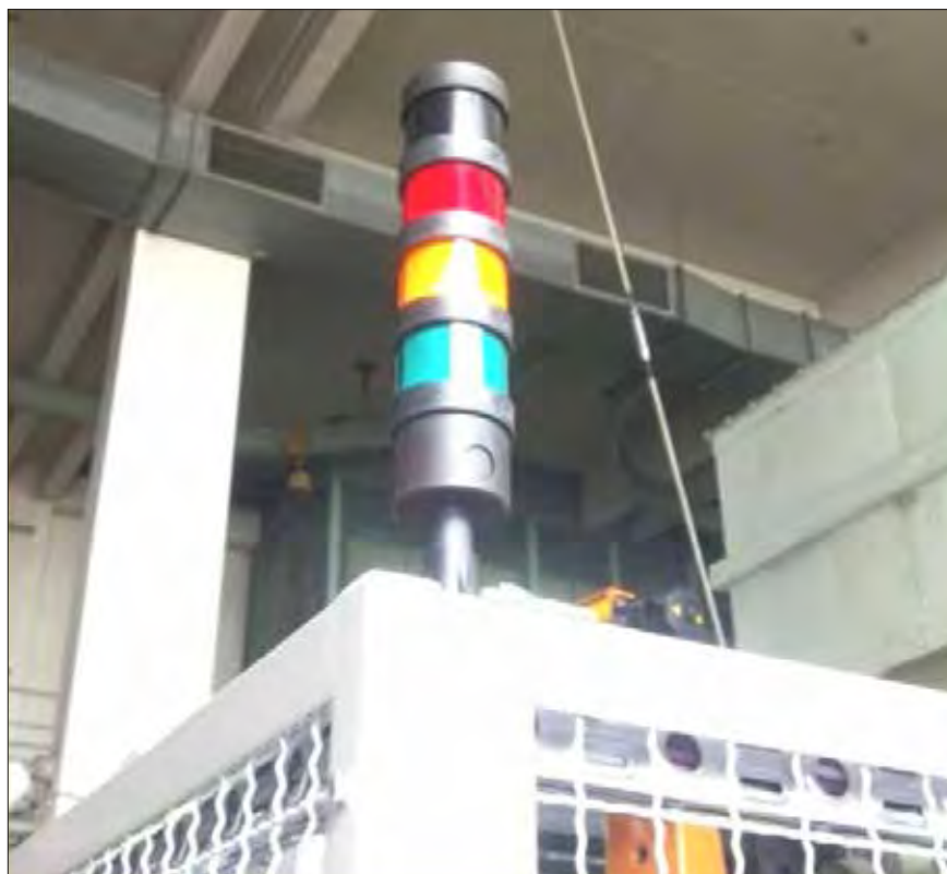
Slika 8. Svetlobni stolp za indikacijo dogodkov 2 st
