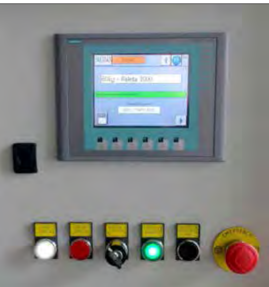
Slika 5. Krmilna omarica z (OP) operaterskim panelom
