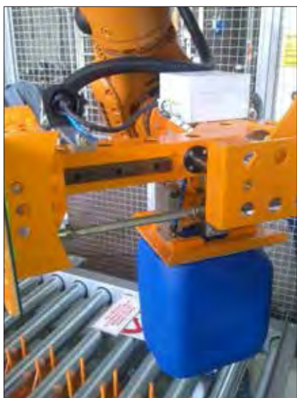
Slika 2. Prijem PVC-posode na valjčnem transporterju
