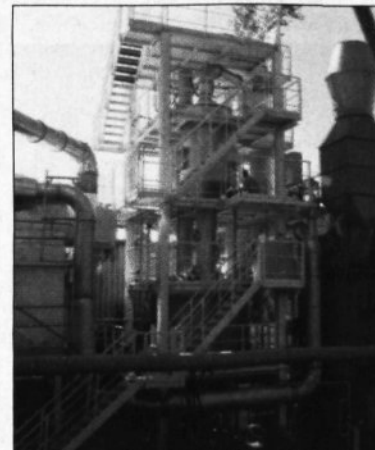
Naprava za filtracijo zraka pri postopkupridobivanja sekundarnega svinca iz odsluženih akumulatorjev v severni Nemčiji
