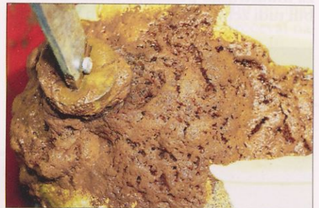
Slika 5. Rezervoar je bil resnično zelo zarjav. Na začetku so iz njega iztekale prav neverjetne količine goste rdečerjave pene.
