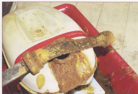
Slika 10. Anoda je na koncu procesa polna oblog iz rje.
