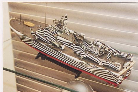
Progasta kamuflaža na torpednem čolnu elco PT naj bi oteževala jasno ocenjevanje razdalje do hitrega torpednega čolna. Vsekakor bo barvanje še težavnejša naloga na maketi v merilu 1 : 72.
