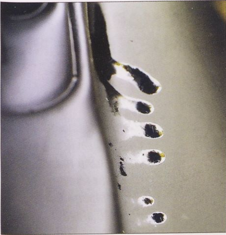
Slika 17. Prvi nanos premaza se je sušil 7 dni.
