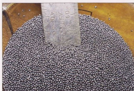
Slika 13. Za mehansko čiščenje sem uporabil majhne jeklene kroglice.
