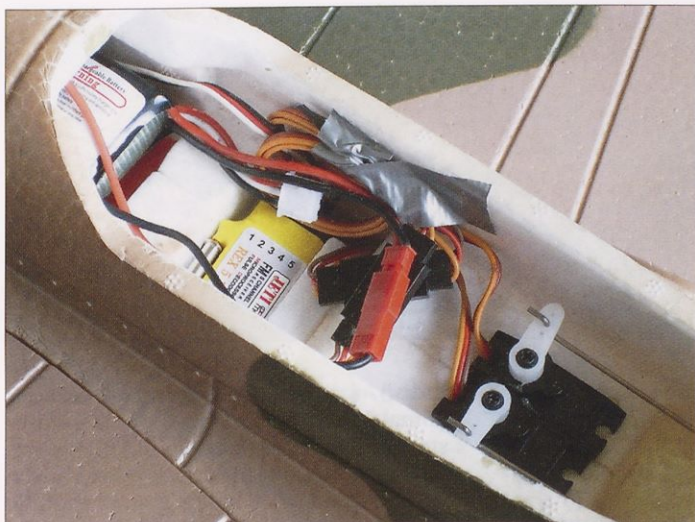
Slika 5. Trup z nameščenim akumulatorjem in sprejemnikom
