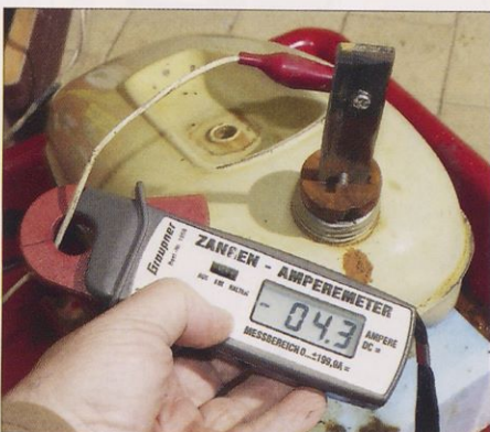
Slika 3. Začetek galvanizacije. Tokovi so odvisni od velikosti anode, prevodnosti kopeli in debeline rje.
