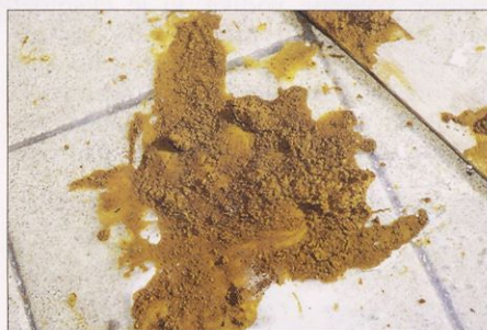
Slika 11. Posušena obloga iz anode je fin prah rdečerrjave barve.
