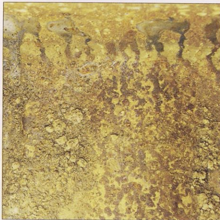
Slika 2. Zaradi rje v rezervoarju se lahko zamaši uplinjač, zato motor ni zanesljiv. Rjo je treba odstraniti.
