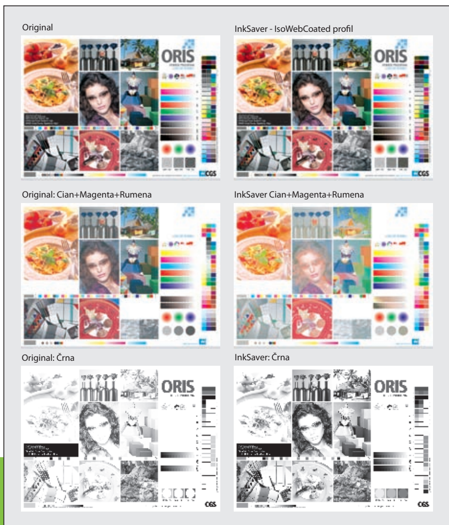
Slika 3: Videz originala (levo) in obdelane datoteke (desno), (Inksaver ISOwebcoated 300 medium (v3).dat) z izvlečki.
