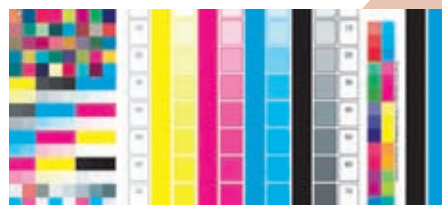
Del testne forme za ICC-karakterizacijo, procesno kalibracijo in nadzor.
