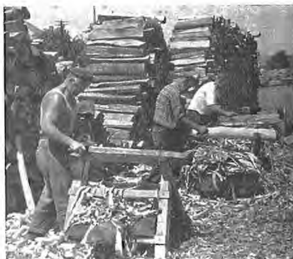
Ročno drzanje bukovega celuloznega lesa z drzalniki. Učinek je ok. 3–7 m 2 /h, odpadek pa 8–16% (Orig.)
