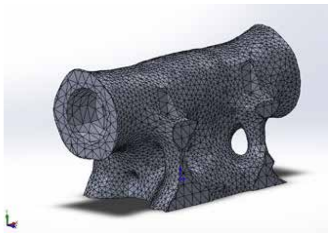
Slika 8 : Volumski model kot rezultat topološke optimizacije novega ohišja ventila
