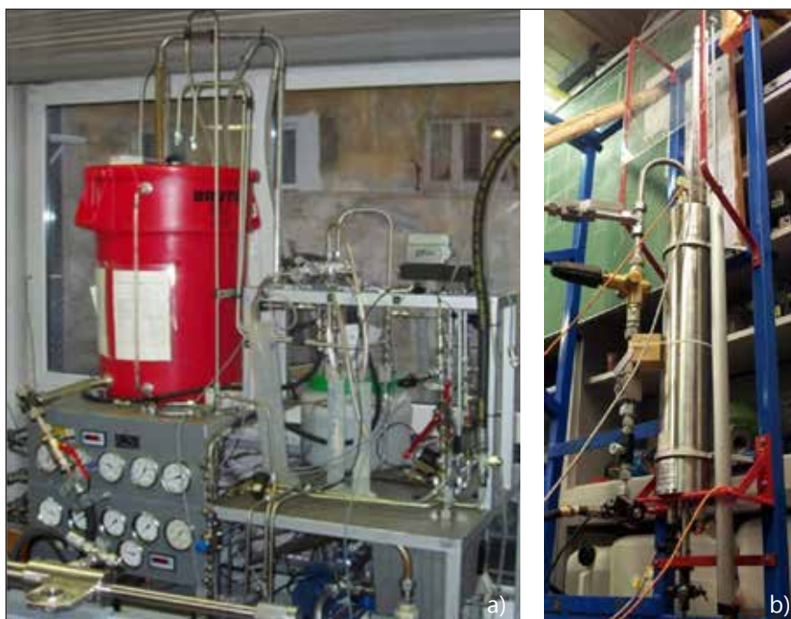
Slika 2. a) Vodno preizkuševališče, ki je preko gibke cevi povezano z batnim plinskim akumulatorjem v vertikalni legi.
