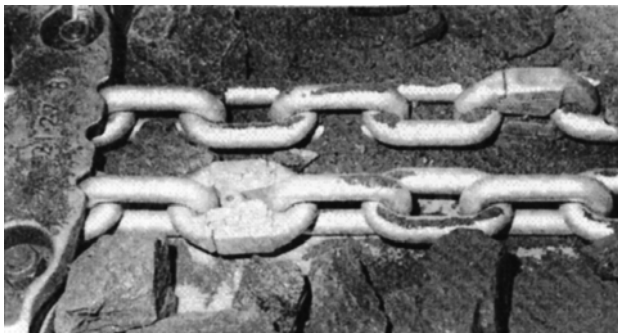
Slika 2: Verige in členi so korozijsko zaščiteni s sistemom obdelave "KORROTHERM". Celoten preizkus je opravljen po DIN 22258
