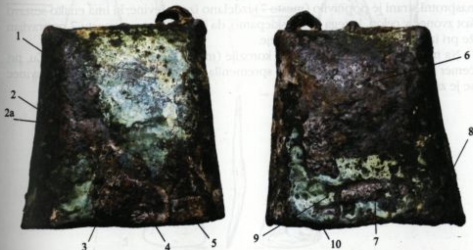
Sl. 8: Slika prikazuje mesta, označena s številkami od 1 do 10, na katerih je bila opravljena analiza kovine zvonca.
