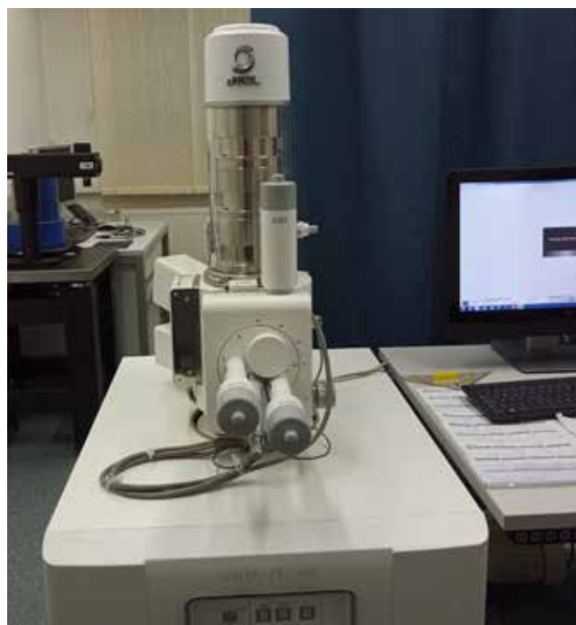
Slika 2 : Elektronski mikroskop JSM-IT-100 proizvajalca JEOL
