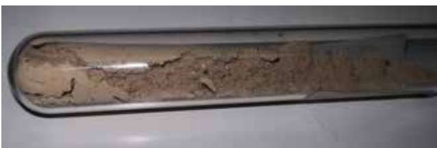
Slika 4 : Vzorec opazovanega testnega prahu (MTD po ISO 16889)
