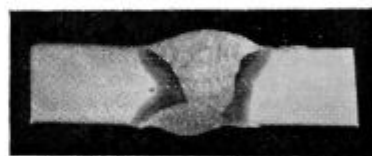
Slika št. 5 Zvarni spoj HPA — 10 z žico VAC 70 (Mo)
