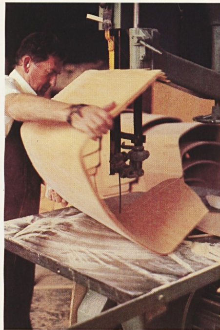
Obrezovanje prostorskih krivin (na tračni žagi v PE 8), kot je tale za kinofotelj, zahteva mirno roko in precej rutine.
