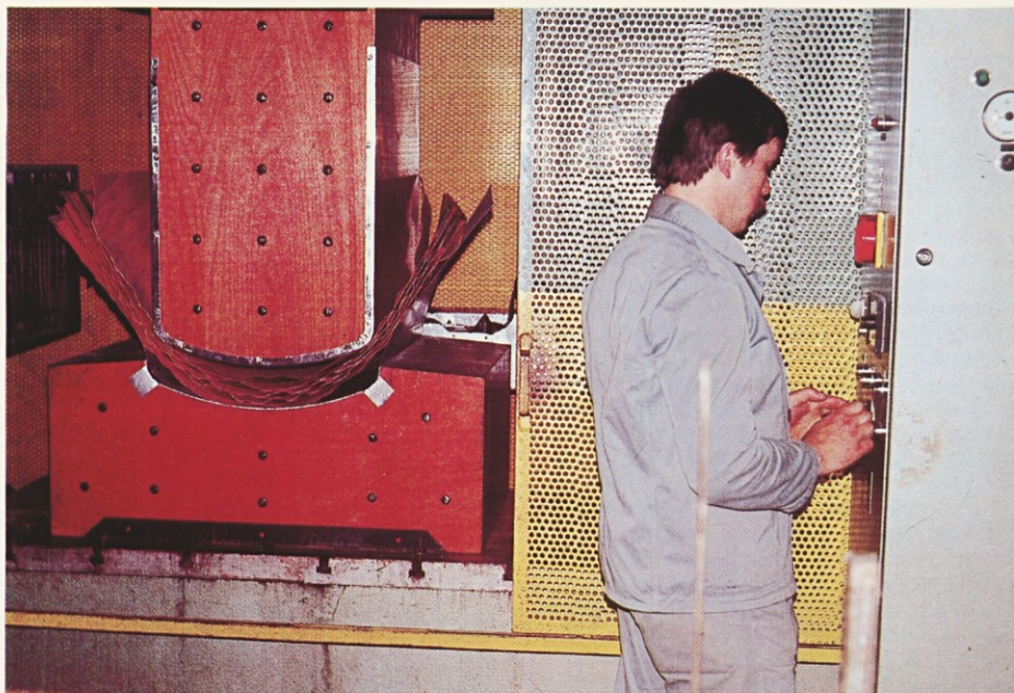
V furnirskem obratu (PE 6) v tozdu 1 je pred časom pričela obratovati sodobna stiskalnica z vertikalnimi in horizontalnimi pritiski. Namenjena je izdelavi lameliranih elementov, ki so osnova za celotni L program, za počivalnik Bendi in drugo. Tudi tu poteka sušenje s pomočjo visokofrekvenčnega generatorja.
