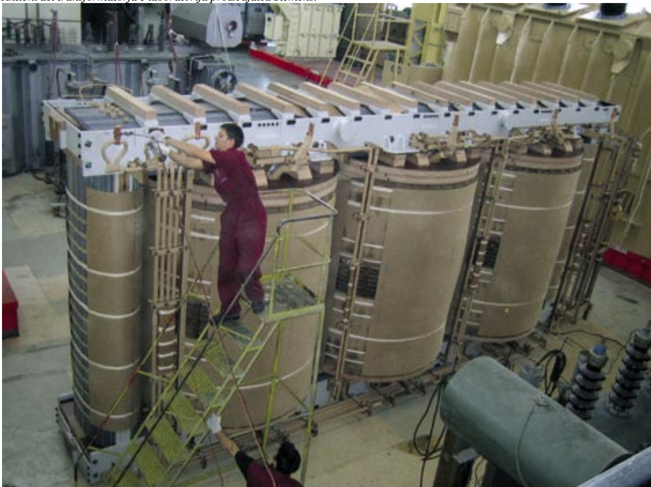
Aktivni del transformatorja v laboratoriju proizvajalca Siemens.
