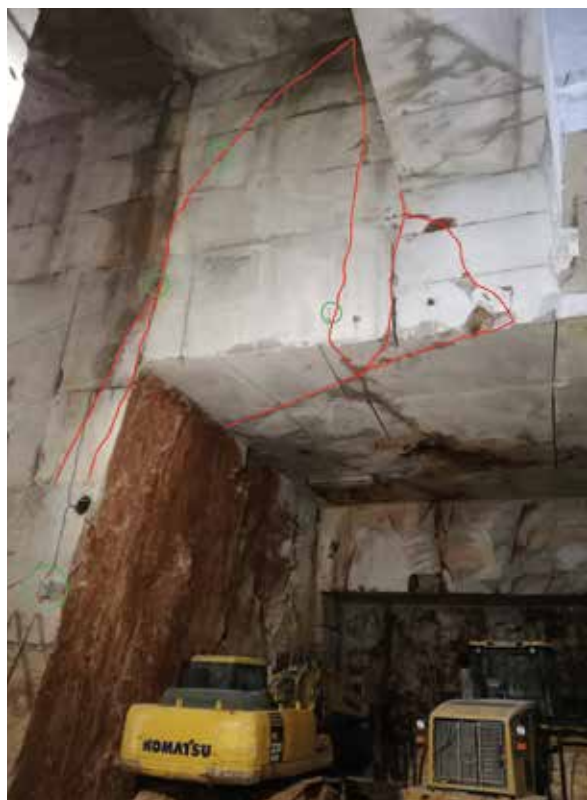
Slika 4: Niša N4 z nameščenim klinom (rdeča) ter tremi merilci premikov in datalogerjem (zeleno)
