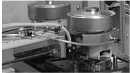
Sl. 7. Prijemalo za motor Fig. 7. A motor gripped by tongs
