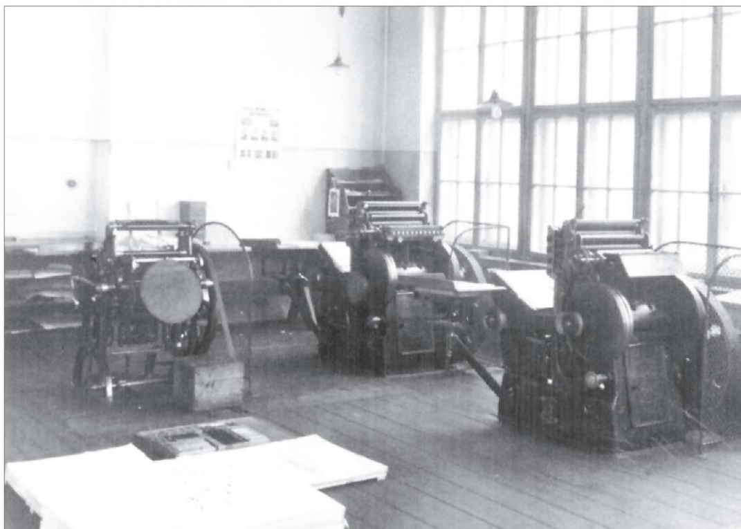
Mali tiskarski stroji (tigli) v Mohorjevi tiskarni v Celju. Slika hrani Zbirka Josipa Pelikana, MNZ Celje.
