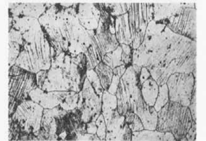
Slika 2: Jeklo z 1% C in 12% Mn po dobrem gašenju: že med poliranjem za pregled površine se utrži površina zrn s plastično deformacijo. Smeri drsenja jekla niso enake v vseh zrnih. Povečava 100-krat.
