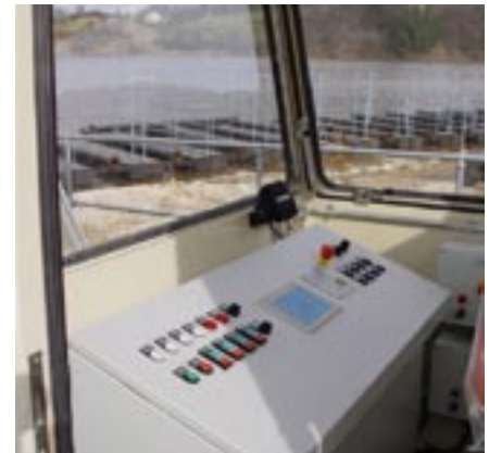
Kabina z lokalnimi komandami in kontrolnimi instrumenti za ročno upravljanje črpanja stare sadre
