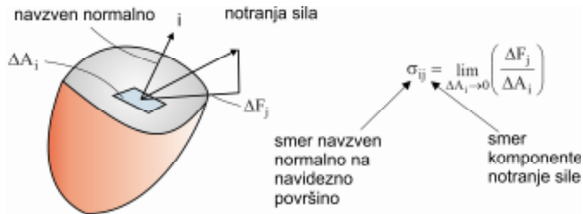
Slika III.3: Prikaz delovanja napetosti v točki
