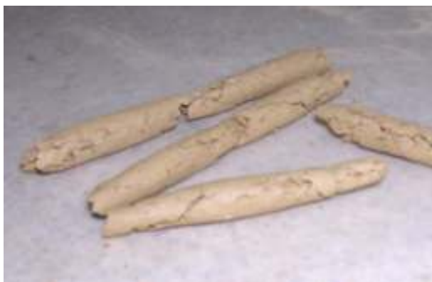
Slika IV.11. Določanje meje plastičnosti.
