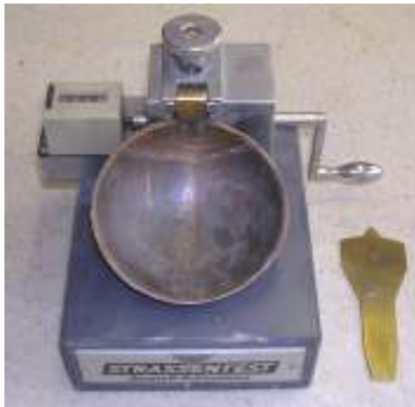
Slika IV.7. Casagrandejev aparat za določanje meje židkosti in kovinska profilna ploščica.
