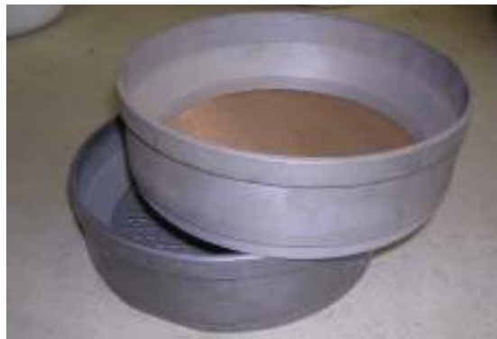
Slika IV.1. Sita za določanje velikosti zrn večjih od 0,06 mm.
