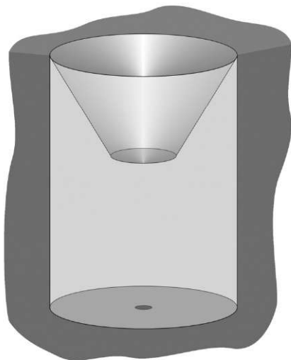
Sl. 6: Primer talne pasti živolovke za vzorčenje v populaciji bukovega kozlička ( Morimus funereus ). Risba: Andrej Kapla.
