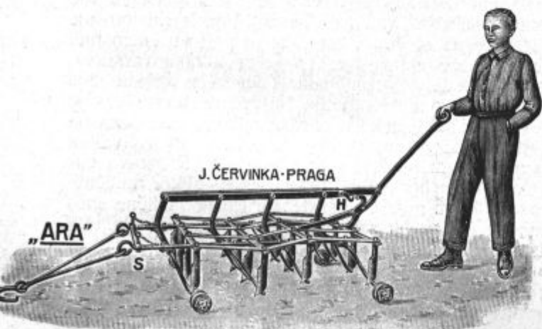
Pod. 27. Travniški kultivator „Ara“, dvignjen iz zemlje s pomočjo vzvoda.
