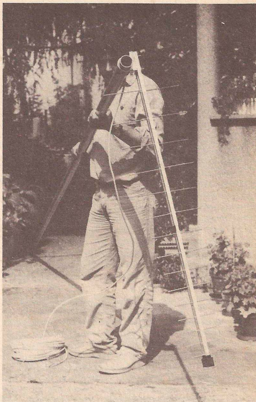
Sodobna kombinirana VHF-UHF antena za III., IV. in V. področje, za kanale 5—12 in 21—69, dobitek antene 7,5—8,5 dB, priključek 75-ohmski, izdelek Iskre, tovarne antenskih naprav, Vrhnika.
