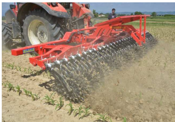
Slika 24: Zvezdaste okopalne elemente odlikuje dobro samočiščenje. (Vir slike: Einboeck)
