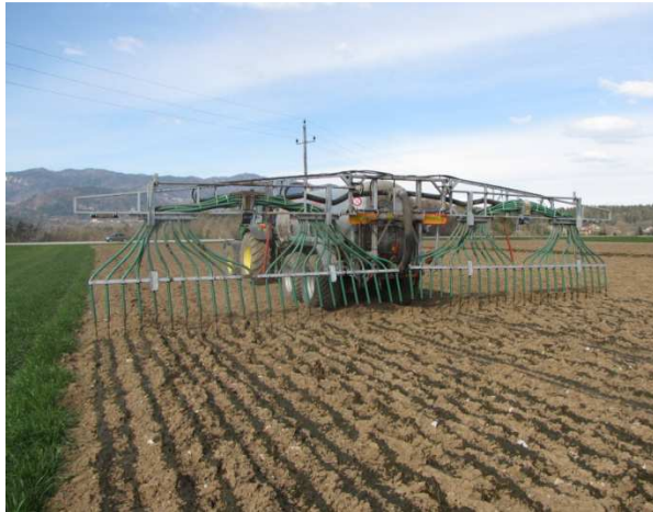
Sliki 4 in 5: Cisterna za gnojevko z napravo za vrstno razdeljevanje gnojevke (razdelilo, kjer gre tekoče organsko gnojilo skozi vlečene cevi) (Foto: Tomaž Poje, KIS in Gregor Turšič)
