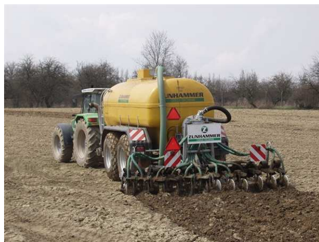
Slika 9: Razdelila s kombiniranim (združenim) strojem za istočasno obdelavo tal in nanosom tekočih organskih gnojil (Vir slike: Zunhammer)
