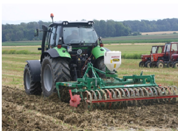
Slika 32: Rahljanje tal in sočasna setev ozelenitve pri konzervacijski obdelavi (Foto: Zita Flisar–Novak, KGZ Murska Sobota)
