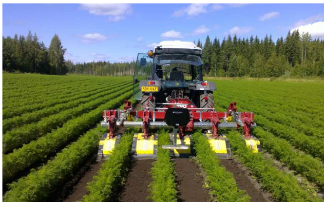
Slika 25 in 26: Segmentni prekopalnik lahko preintenzivno obdelata tla v medvrstnem prostoru. (Vir slike: Badalini)
