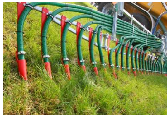
Sliki 6 in 7: Cisterna za tekoča organska gnojila z razdelilom, kjer gre tekoče organsko gnojilo skozi vlečene sani (Vir slike: Vogelsang)
