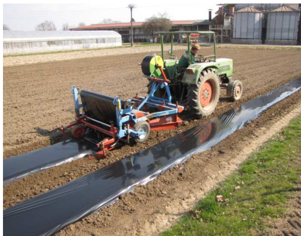
Slika 18: Z gredičarjem oblikujemo gredico in istočasno položimo folijo ter cev za namakanje (Foto: Tomaž Poje, KIS)
