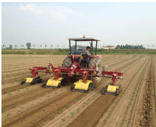
Slika 25 in 26: Segmentni prekopalnik lahko preintenzivno obdelata tla v medvrstnem prostoru. (Vir slike: Badalini)
