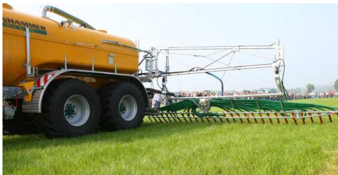
Sliki 6 in 7: Cisterna za tekoča organska gnojila z razdelilom, kjer gre tekoče organsko gnojilo skozi vlečene sani (Vir slike: Vogelsang)
